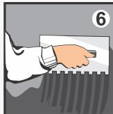
Нанесите клей зубчатым шпателем. Уложите плитку в течение 20 минут после нанесения клея на основание. Выровняйте плитку в течение 15 минут.
